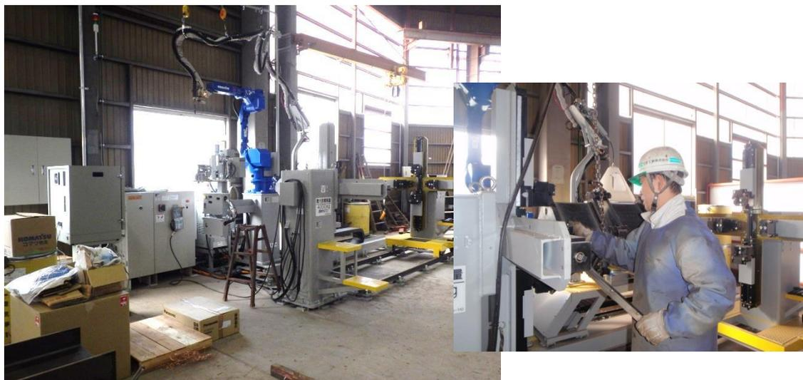
(導入した新型鉄骨溶接システム)
