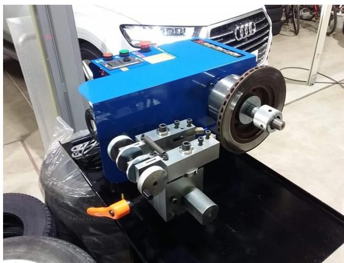
（新たに導入したディスクローター研磨機）
